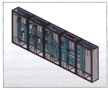
Bild 3: 48 Meter Schaltschrank werden für die Steuerung der Großmolkerei benötigt. Ouelle: JM Hardwarekonzepte
